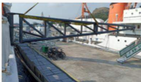
Confecção de braço de arrasto de equipamentos científicos
