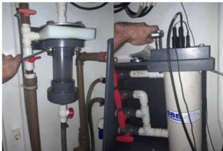
Figura 6. Manutenção do termosal e o Debubbler.
