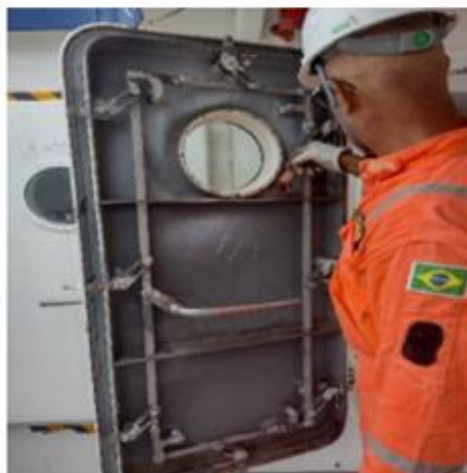
Figura 4. Manutenção de portas estanques e gaiuta.
