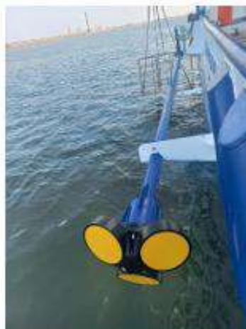
Figura 15. Equipamentos científico do tipo ADCP instalado no lado da embarcação por um braço hidráulico.
