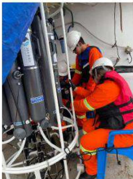
Figura II.5 - Operação de desmame das garrafas.
