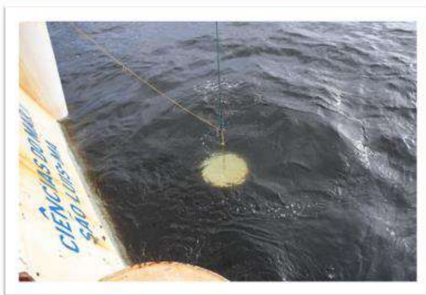
Figura II.19 – Operação com o disco de Sechi.
