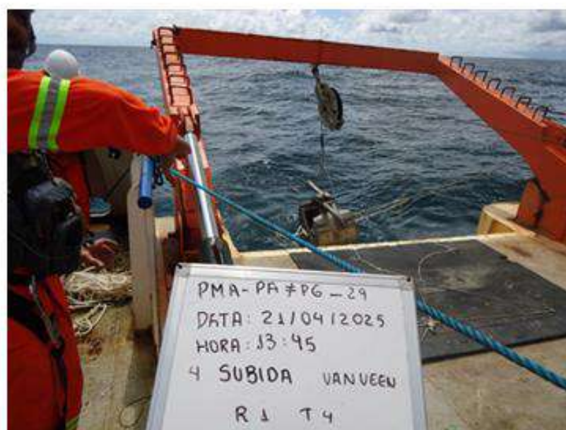
Figura II.25 – Operação com a Van Veen.
