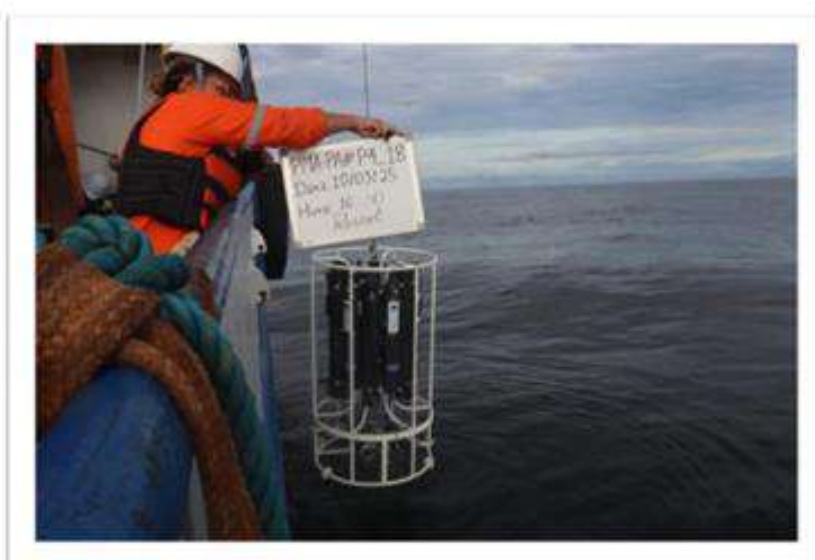
Figura II.16 – Operação com a Rosette pelo guincho de boreste.
