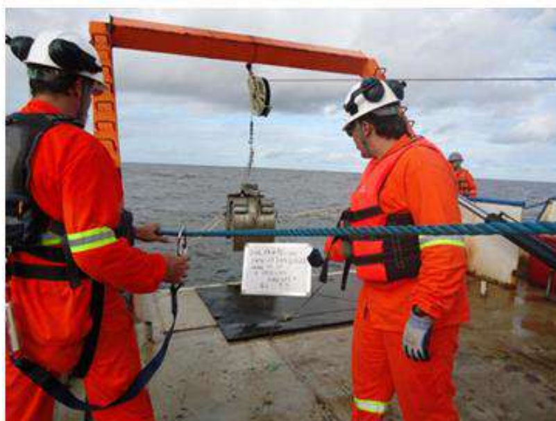
Figura II.27 – Operação com a Van Veen.
