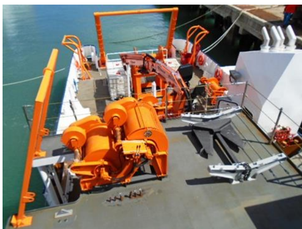
Figura 15a: Equipamentos de convés e âncora (casco 653).
