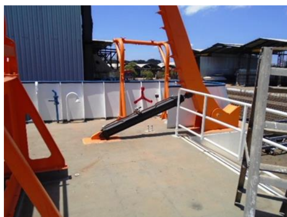
Figura 18b: Pistão hidráulico do “A” frame (casco 653).
