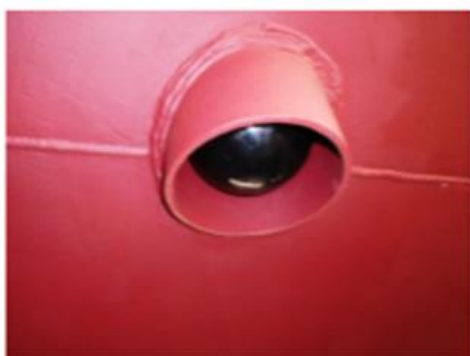
Foto nº 6 – Transdutor do Sonar montado
