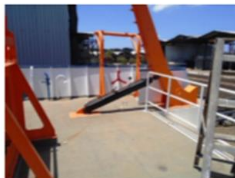
Foto nº 4 – Pistão hidráulico do "A" frame
