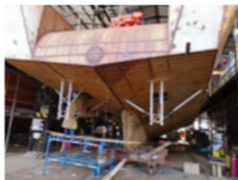
Foto nº 24 – Longitudinal lateral cortada Foto nº 25 – Instalação eixos propulsores 655
