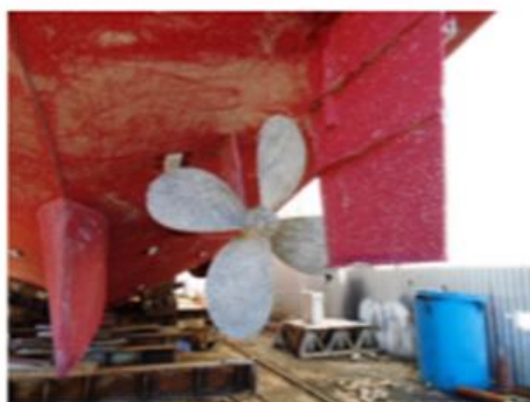
Foto nº 10 – Marcas de incrustação
