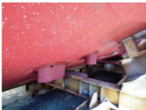
Foto nº 4 – Domos para equipamentos
