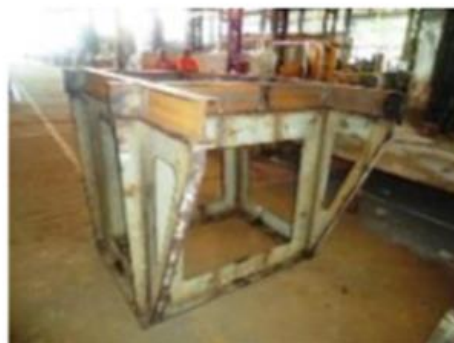
Foto nº 11 – Base do enrolador de rede
