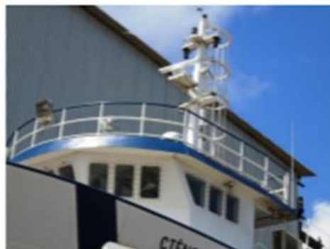
Foto nº 2 – Antena do radar NAVNET
