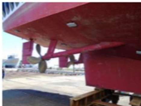
Foto nº 9 – Marcas de incrustação
