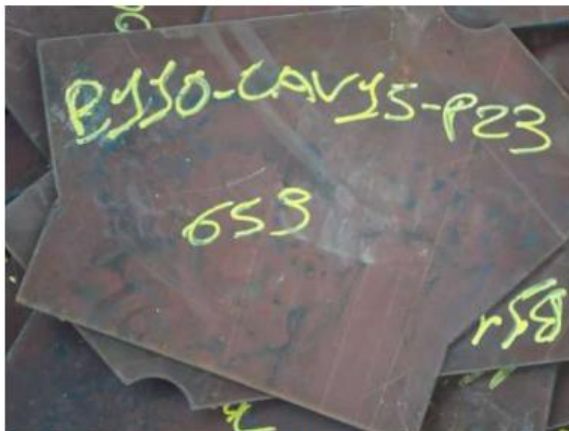
Foto 3 - Peças cortadas e já identificadas.
