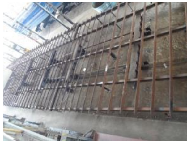
Figura 12b: Embarcação 654 com a estrutura do jig montado.
