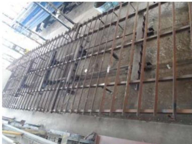
Foto 5 – Embarcação 654 com a estrutura do jig montado.
