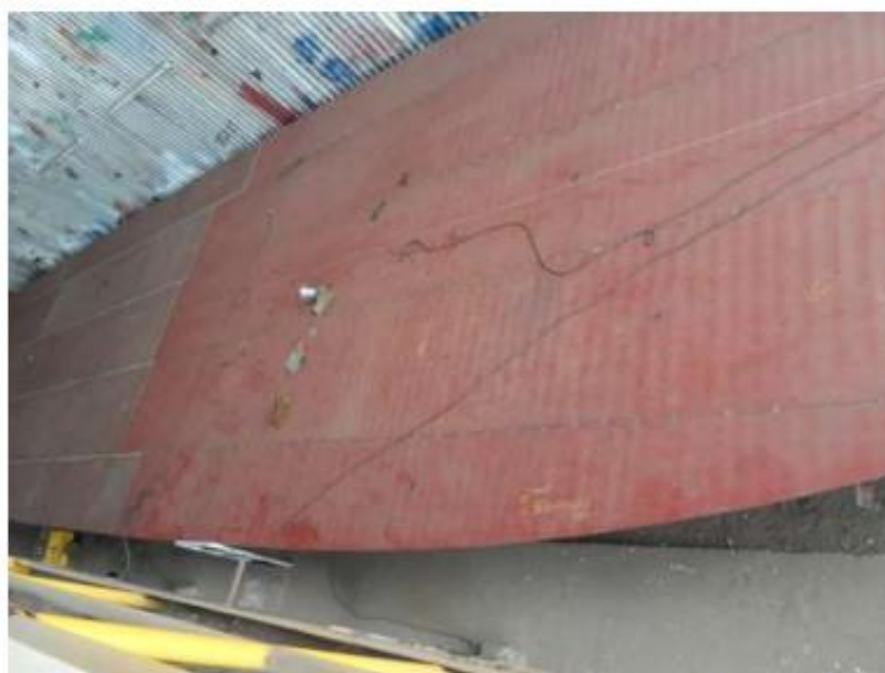
Foto 4 – Convés principal da embarcação 653 já montado e parcialmente soldado.
