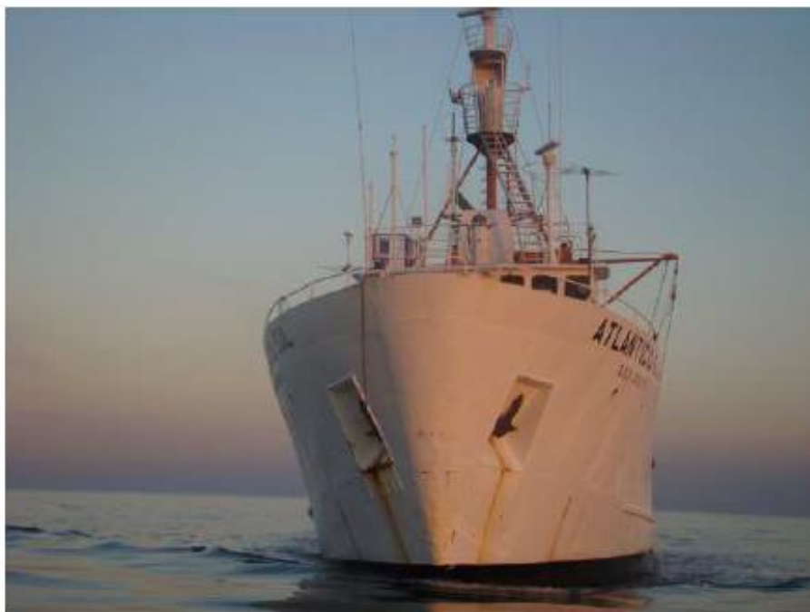
Figura 2: Vista de proa do N/Pq Atlântico Sul, da FURG, sem deformidades significativas nos seus costados (bombordo e boreste) após 37 anos de uso.
