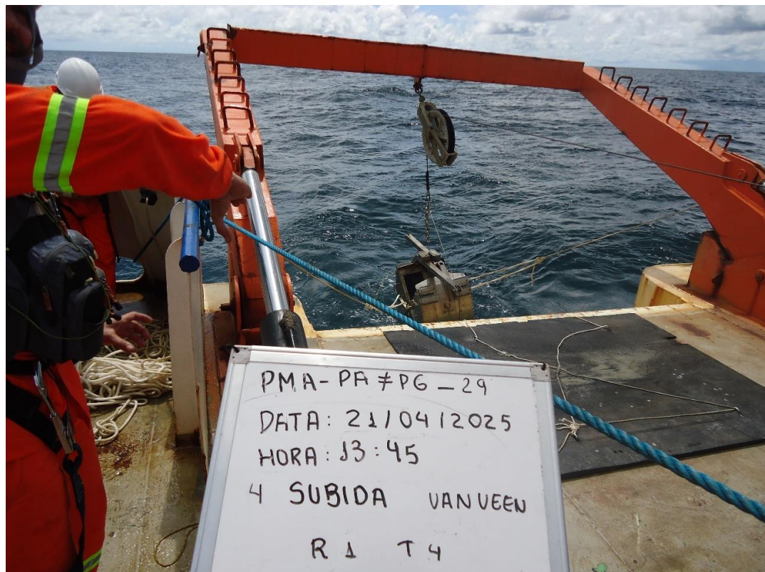
Figura II.25 – Operação com a Van Veen.
