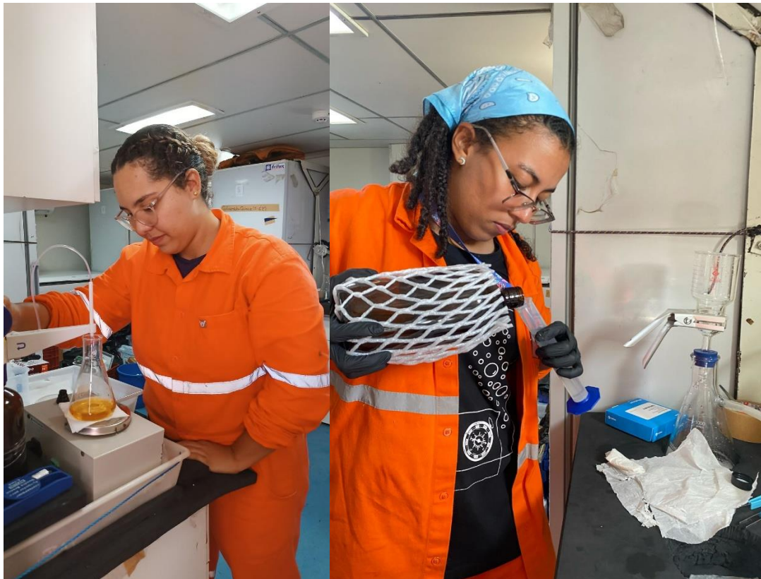
Figura II.6 - Determinação de teor de oxigênio dissolvido e filtração.
