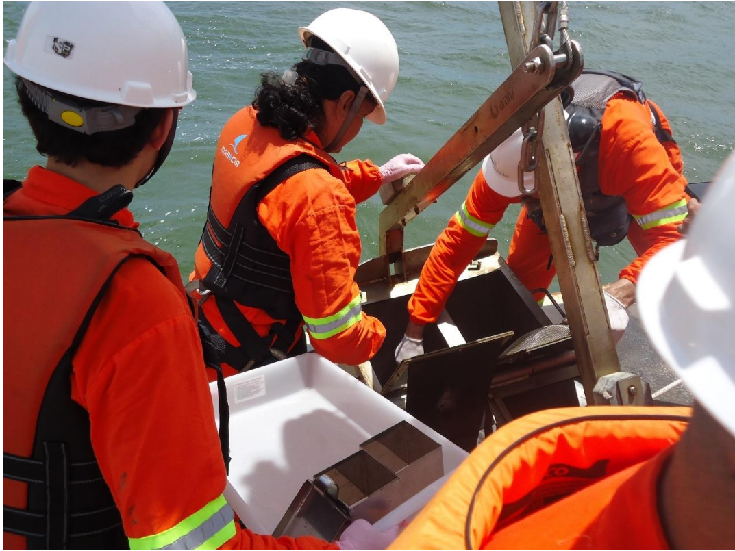
Figura II.28 – Procedimento de amostragem de Bentos.
