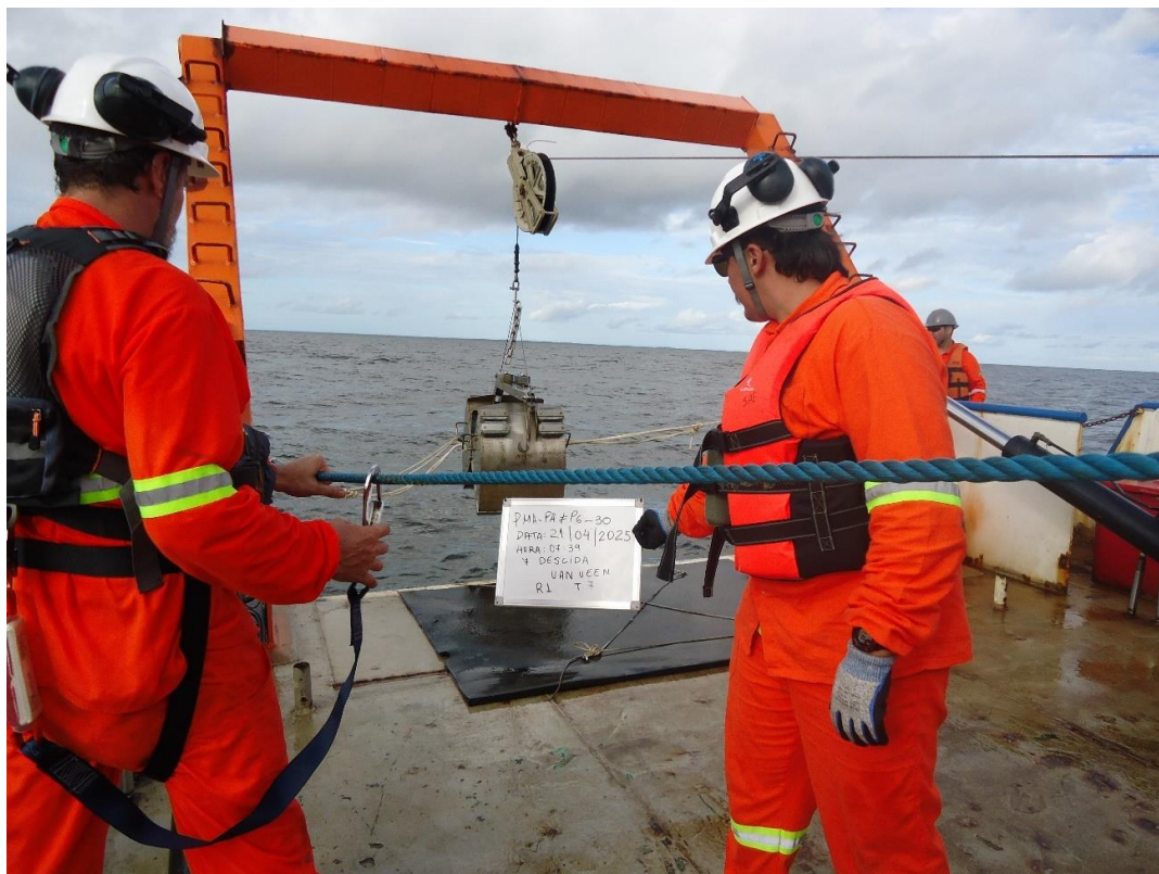
Figura II.27 – Operação com a Van Veen.
