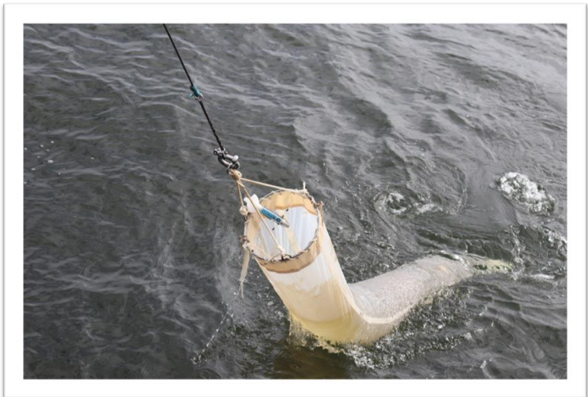
Figura II.18 – Preparação e lançamento da rede de plâncton.
