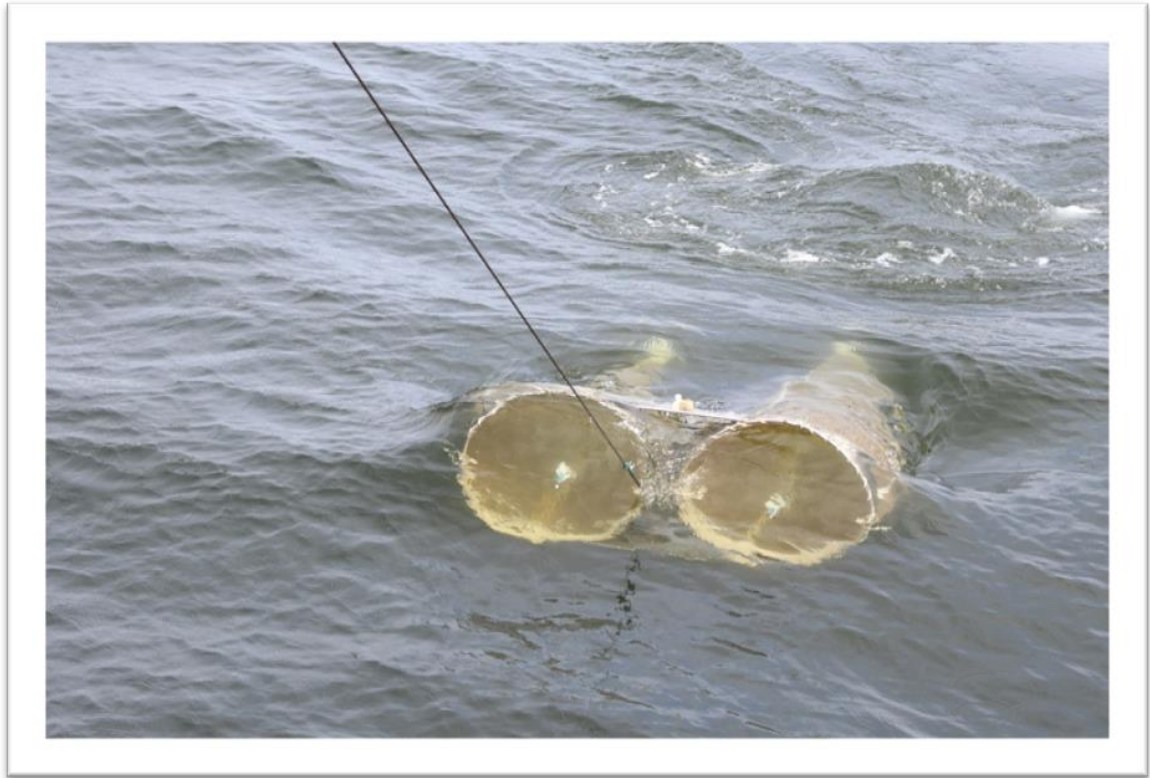
Figura II.17 – Preparação e lançamento da rede bongô.
