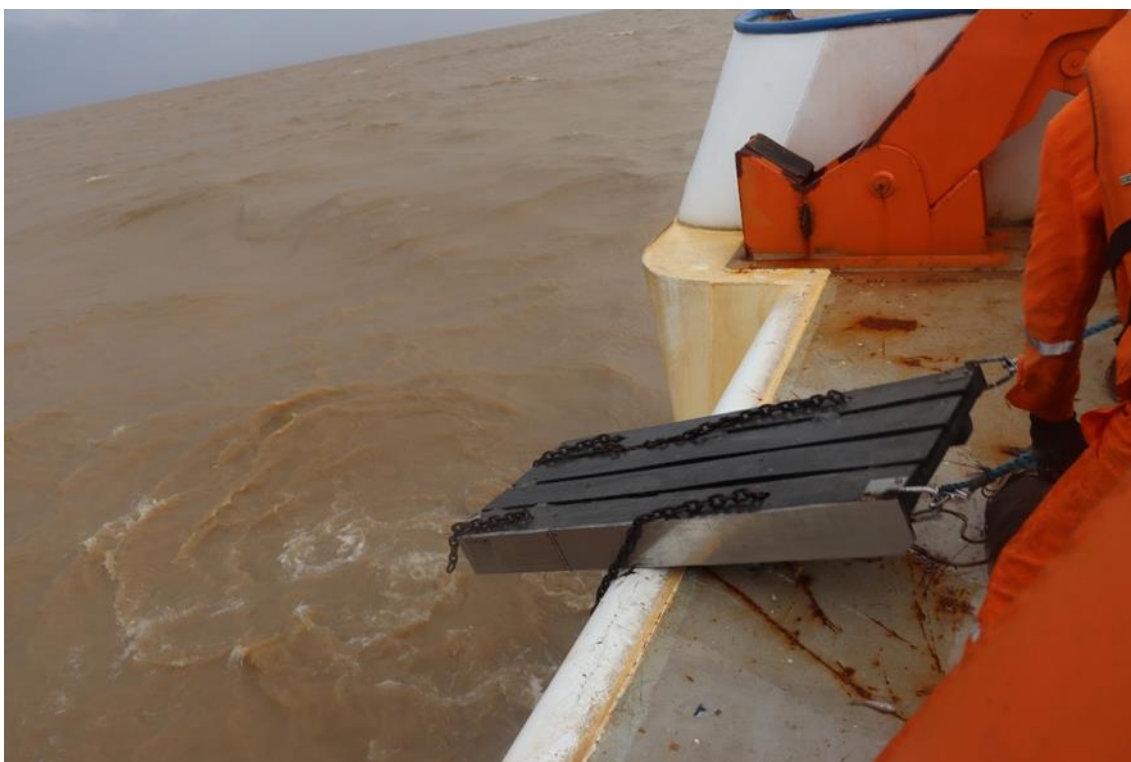
Figura II.13 – Porta remanescente do acidente que resultou na perda da rede de arrasto.
