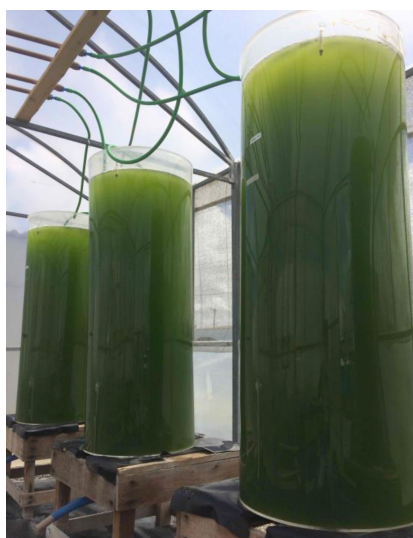
FIGURA 8: Fotobiorreatores para produção de microalgas com borbulamento. Estação Marinha de Aquicultura, Instituto de Oceanografia – FURG (Foto: F. Roselet).
