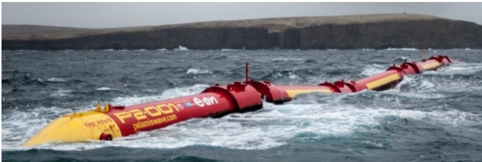
FIGURA 12: Atenuador de ondas Pelamis. Fonte: http://www.emec.org.uk/about-us/wave-clients/pelamis-wave-power/ .
