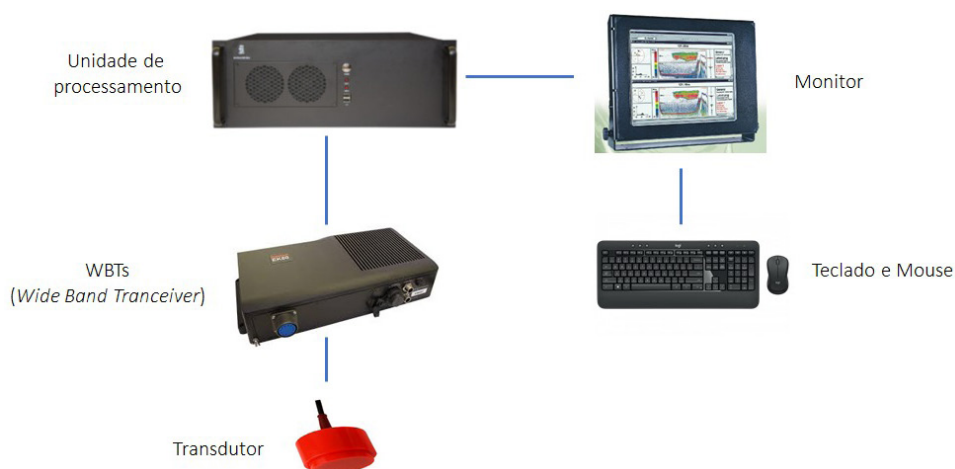
FIGURA 10: Configuração do sistema EK80 com seus componentes principais. Fonte: Manual de operação EK80 SIMRAD Inc.
