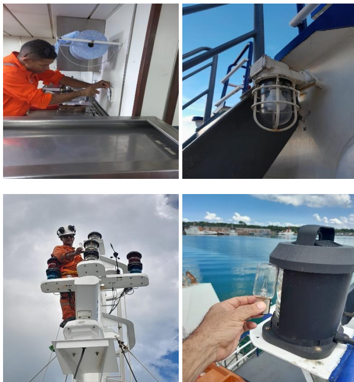
Figura 27. Painel sobrepor e lâmpada tubular substituídos.
