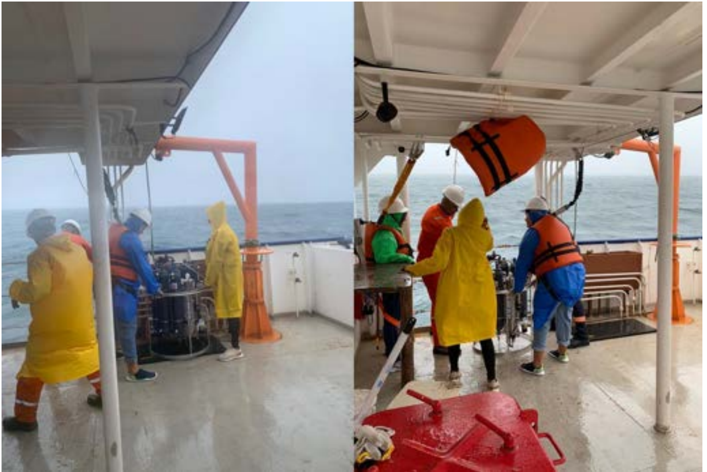
Figura 1 Preparação para amostragem com Rosette composta por CTD e garrafas de niskin para a coleta de água de superfície e de fundo.
