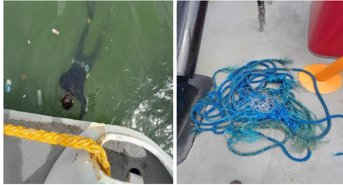
Figura 16. Material removido do eixo do hélice.
