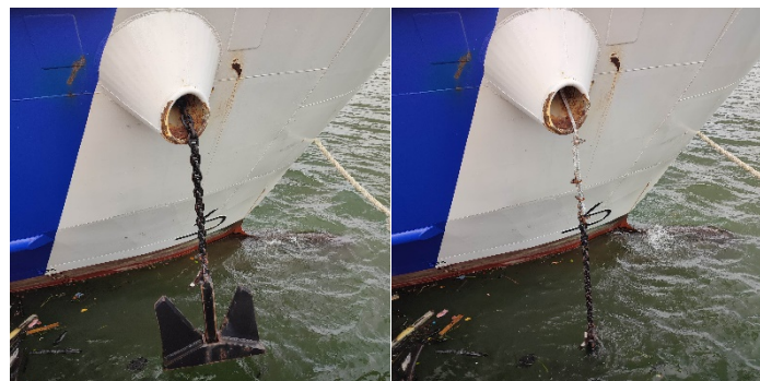
Figura 24. Teste do dispositivo de fundeio.
