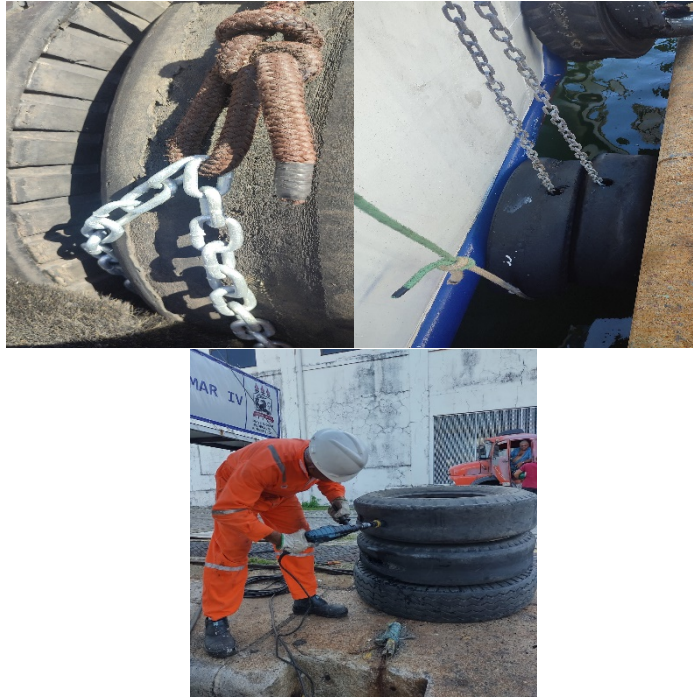
Figura 23. Tripulante inspecionando a amarração e imagem da defesa dobrada.
