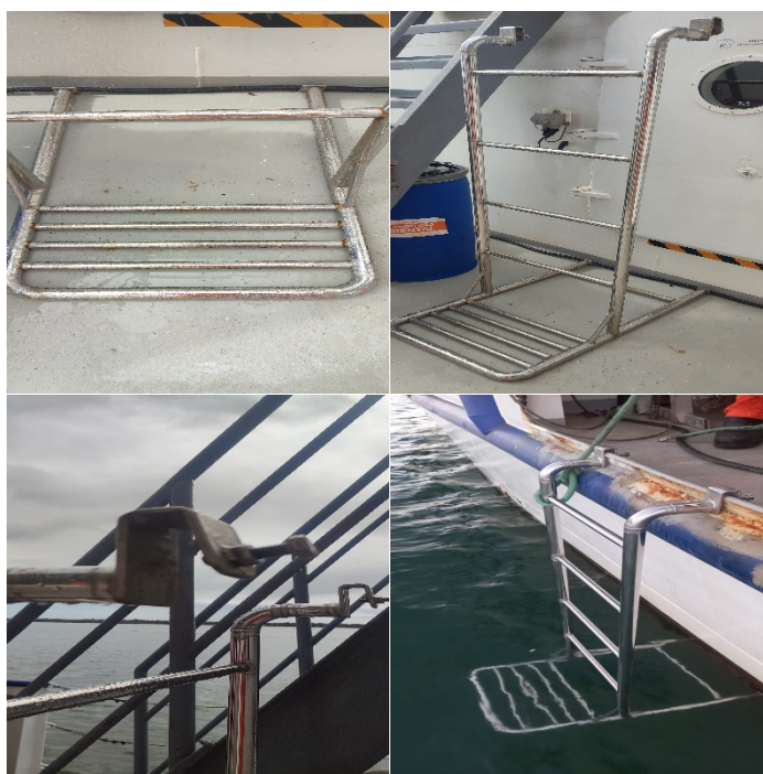
Figura 63. Serviço de fabricação da escada de quebra peito.
