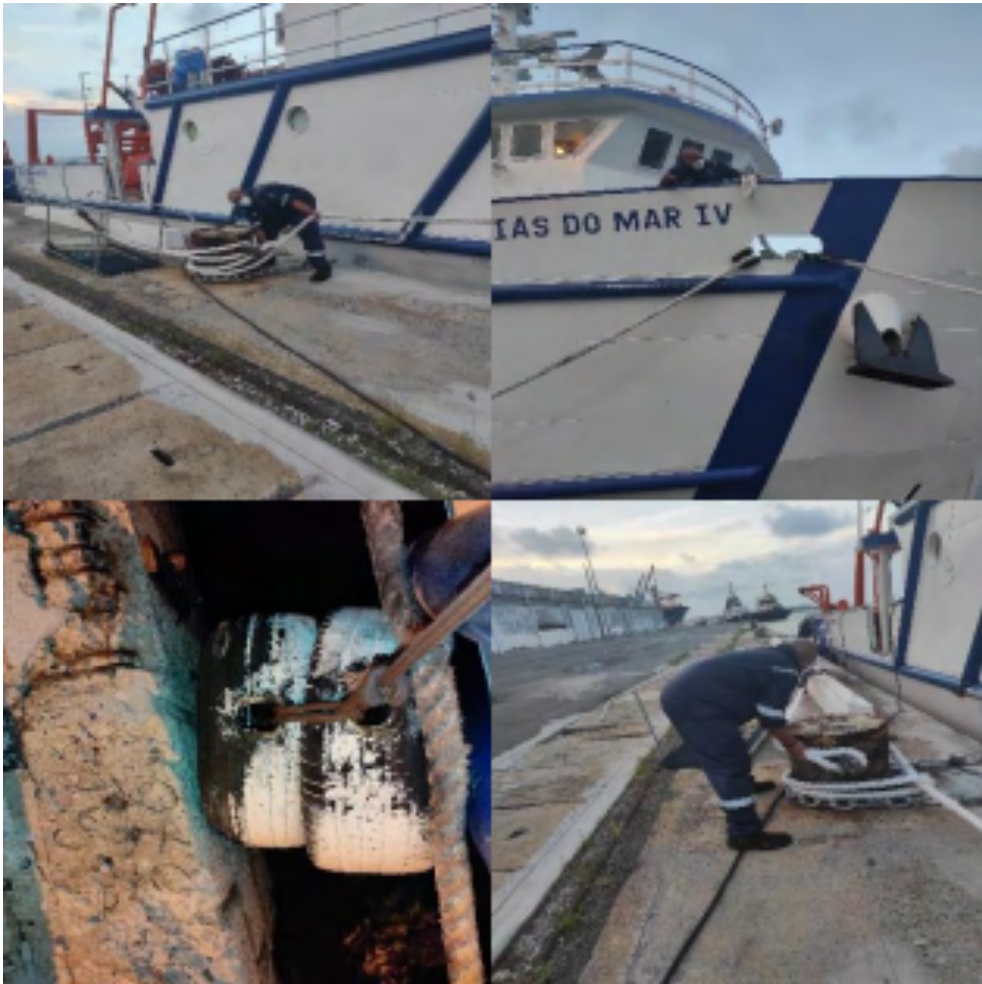
Figura 26 - Tripulante inspecionando a amarração e imagem da defesa dobrada.
