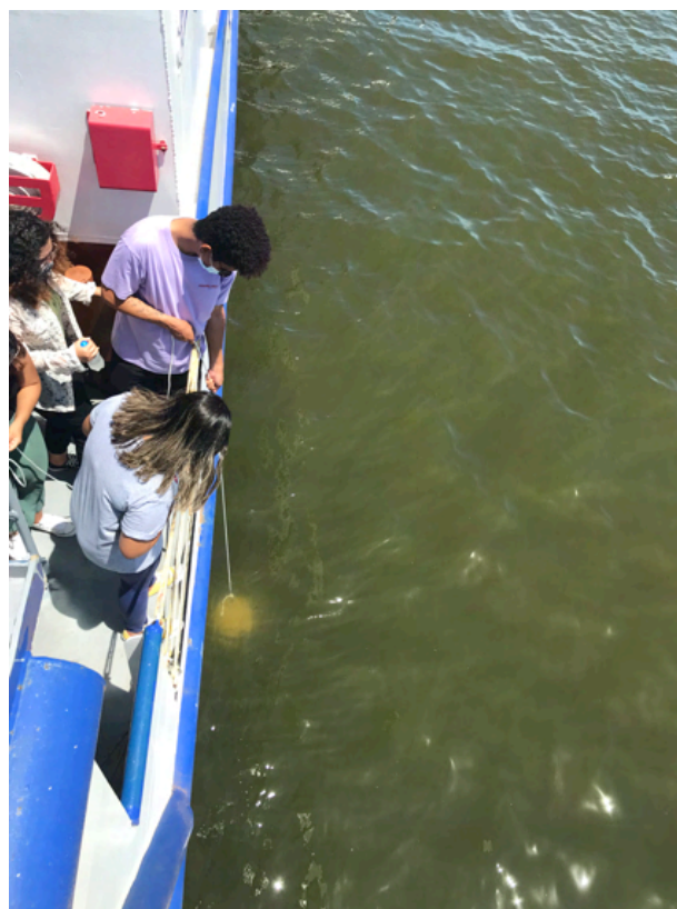
Figura 64 - Alunos operando o disco de secchi a bordo da embarcação.
