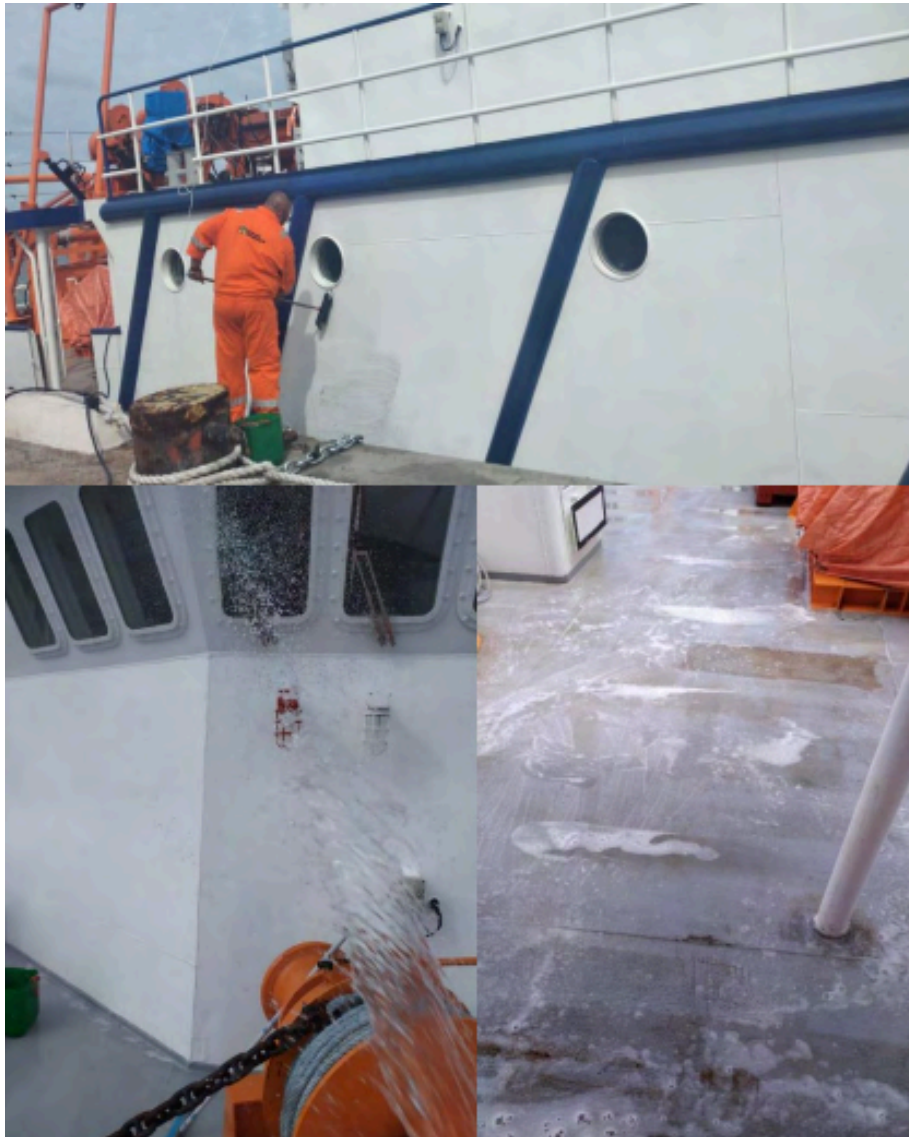
Figura 4 - Serviços de limpeza, convés e costado da embarcação.
