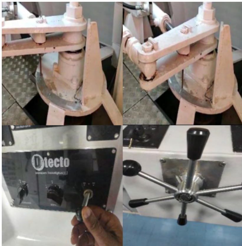
Figura 13 - Variações do ângulo do leme e acionamento em emergência pelo passadiço.
