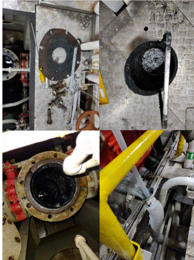
Figura 7 - Serviços de limpeza dos dutos, caixas de mar e colméias de arrefecimento dos motores de combustão principais e auxiliares.
