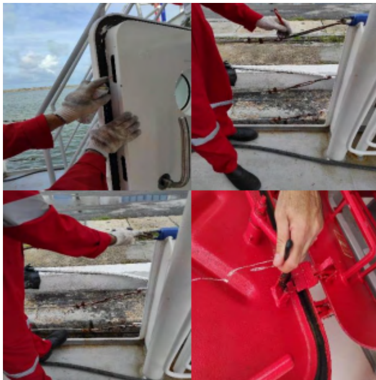
Figura 19 - Lubrificação das portas-estaque, gaiuta e cabos de segurança nas entradas de portaló.
