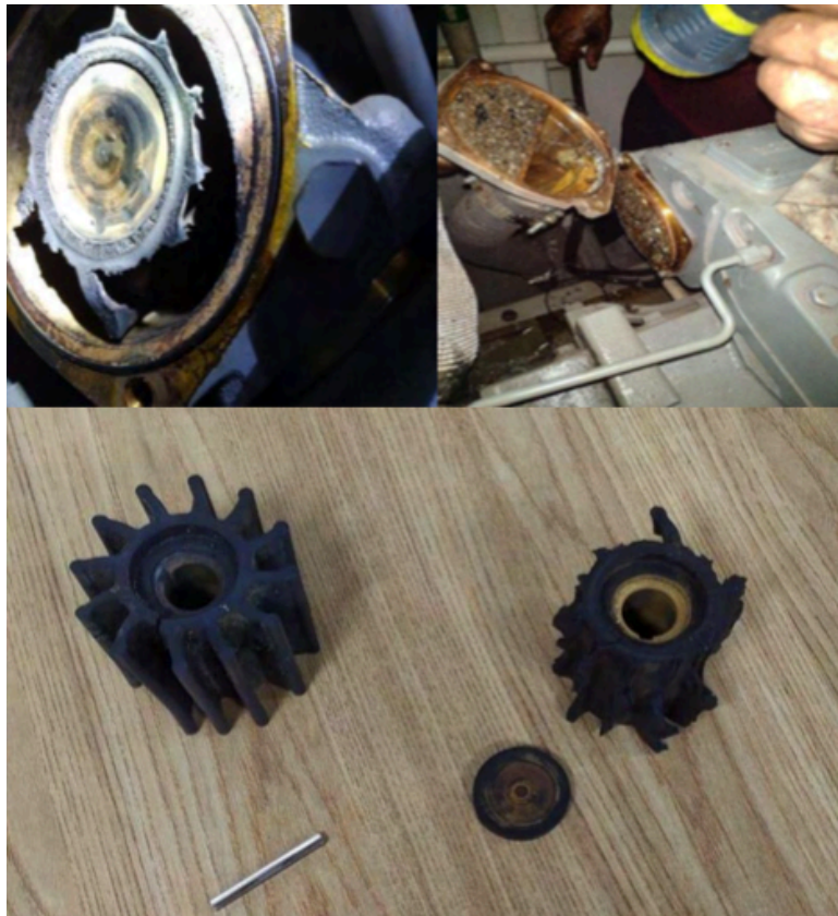
Figura 39 - imagens do rotor com aletas danificadas e trocador de calor do MCA – BE, e a imagem dos rotores com avarias.
