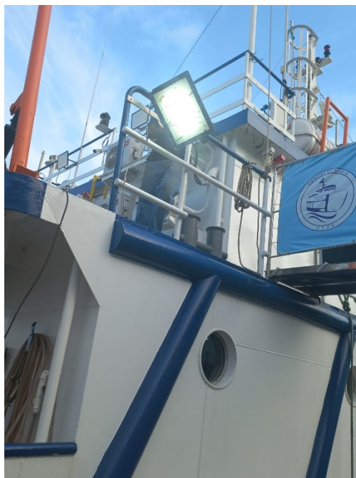
Figura 20. Checagem das lâmpada e estrutura dos refletores.
