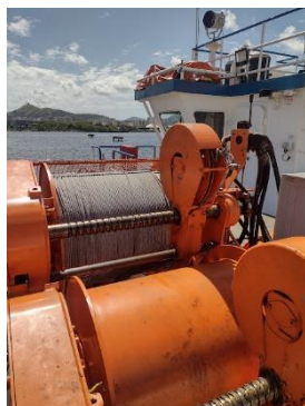
Conserto de espaçador do guincho principal
