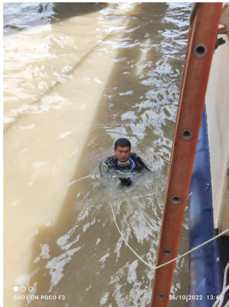
Figura 18 - Retirada de cabo de polipropileno do hélice. O cabo arrastava uma rede de plancton quando se enrolou no hélice. Novembro 2022.
