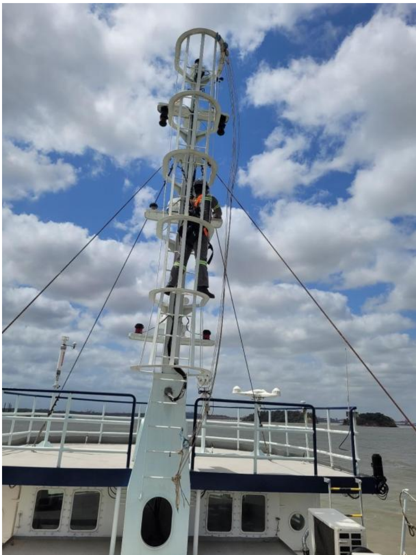
Figura 16 - Manutenção preventiva do sistema de iluminação. Setembro/2022.
