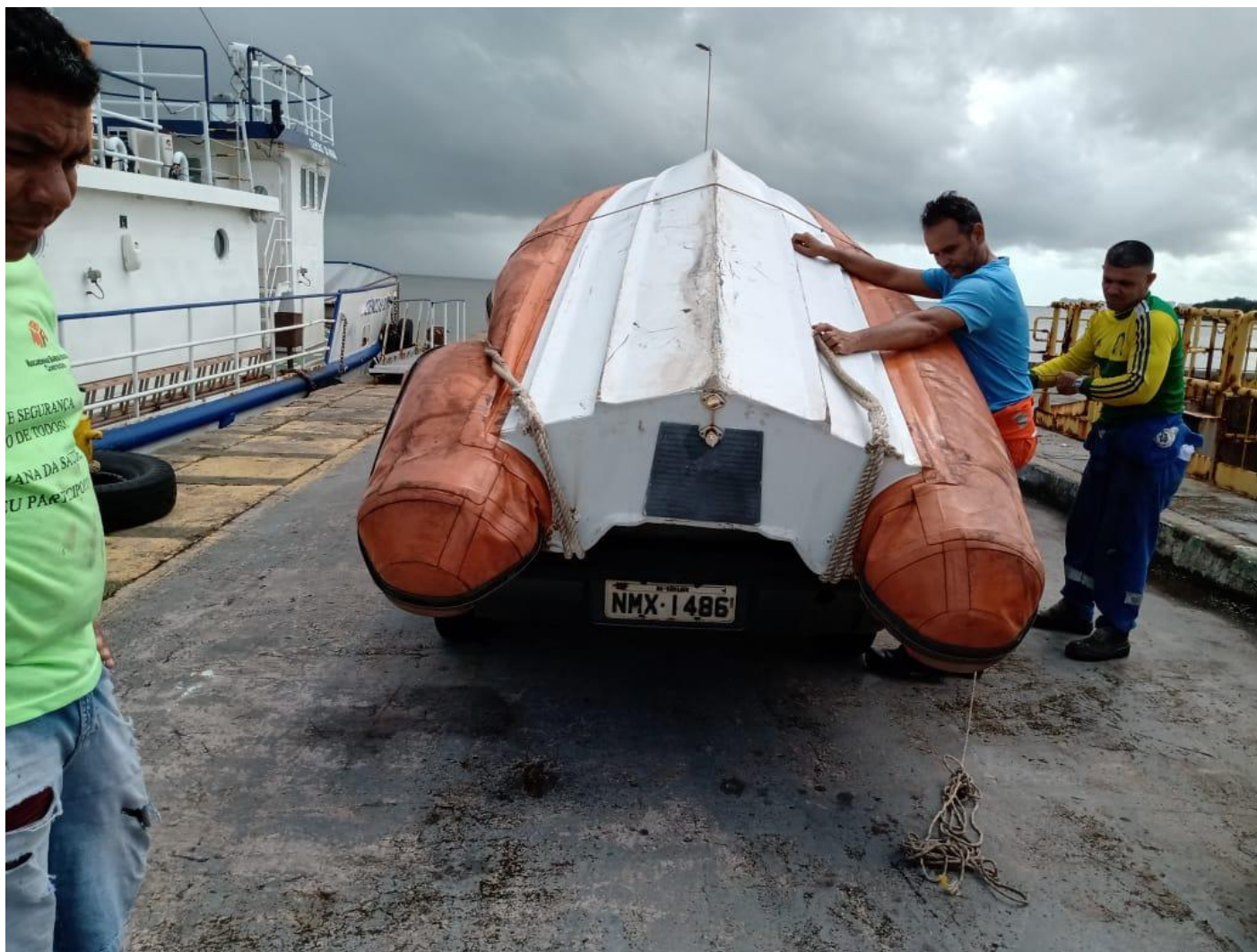
Figura 5 – Manutenção de bote inflável. Foi dada perda total no bote pois não mais consegue colar remendos. Abril/2022.
