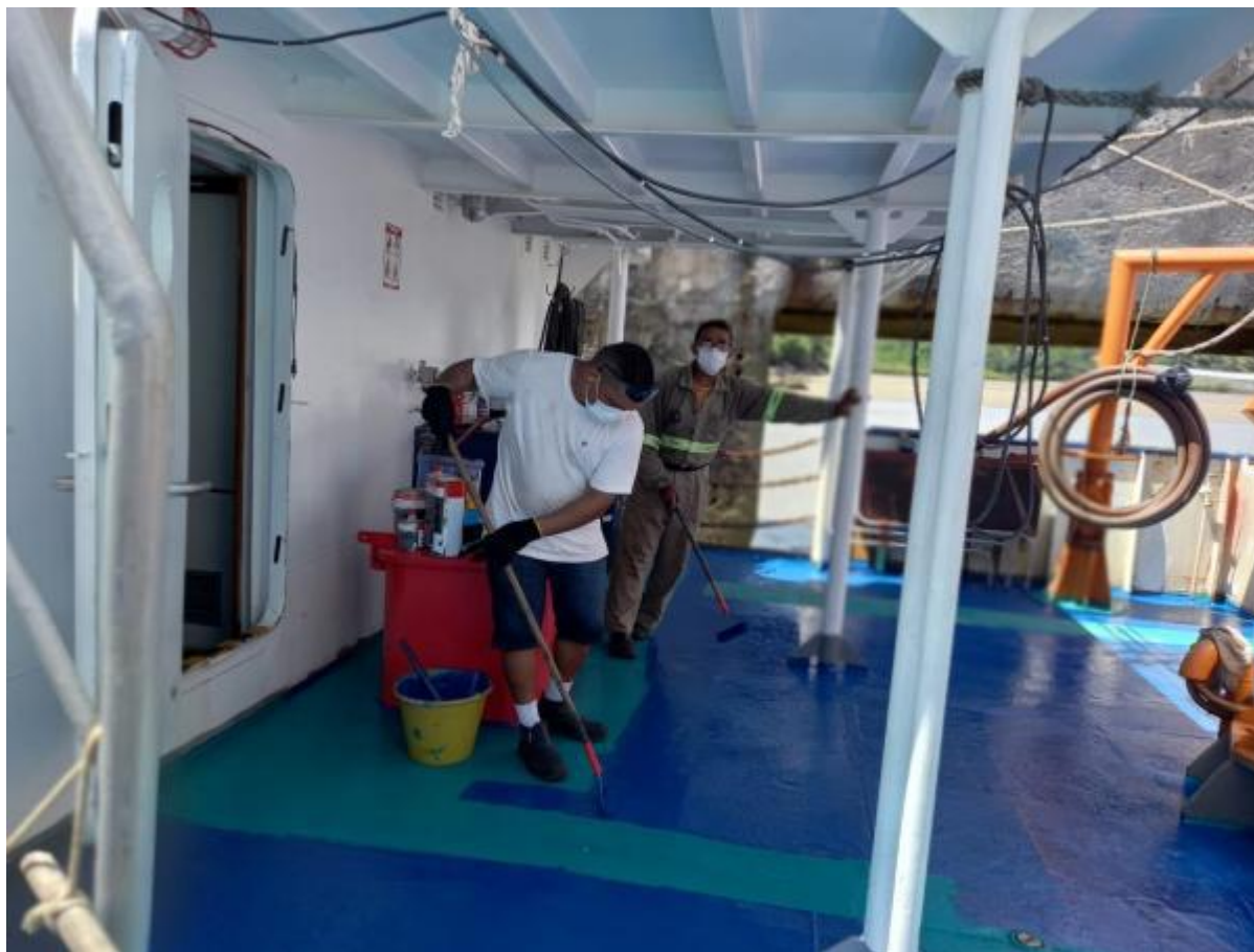
Figura 14 – Pintura contínua do convés e equipamentos. Efetuada no período de seca. Agosto de 2022.
