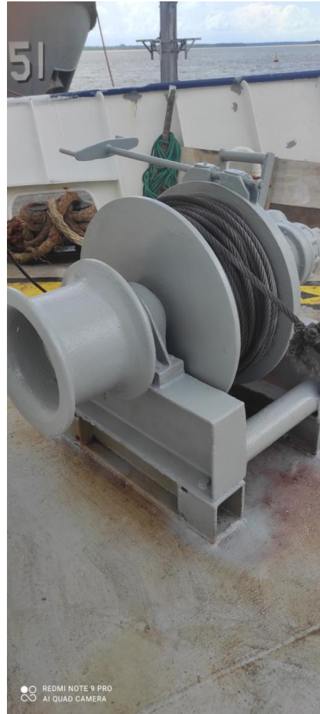
Figura 20 - Manutenção e pintura do guincho da âncora. Dezembro de 2022.
