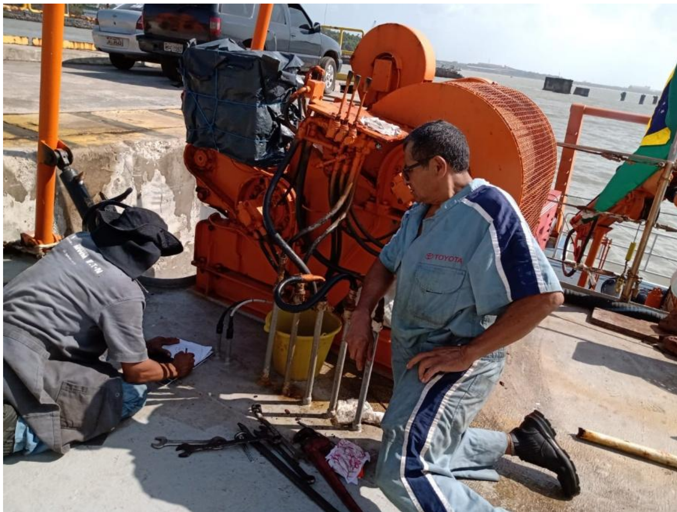
Figura 19 – Manutenção do guincho oceanográfico de boreste. Novembro 2022.
