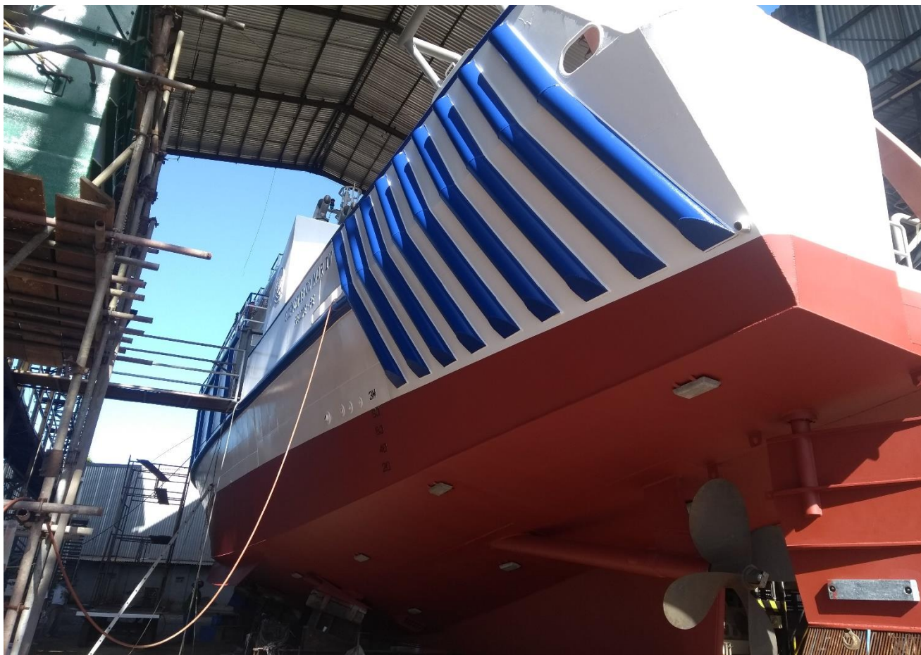
Descrição: Pintura externa do casco. (100% CONCLUIDA)
