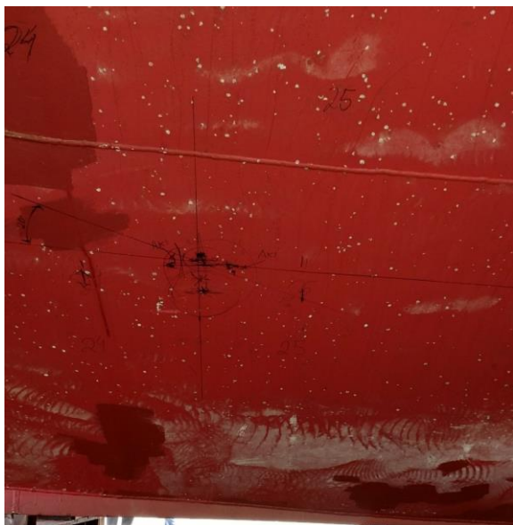
Foto 4: marca p/ instalação da sonda de rede
