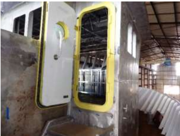
Foto nº 18 – Porta de acesso ao passadiço
