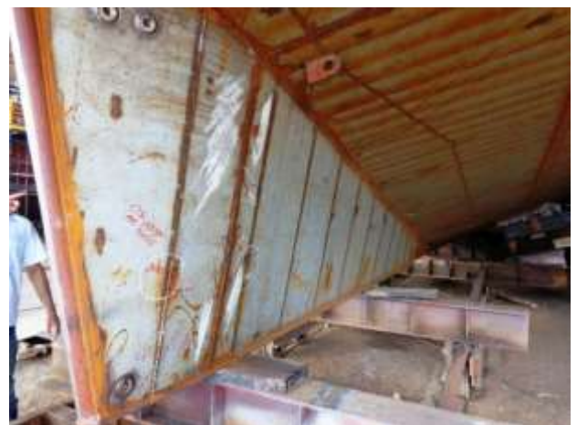
Foto nº 39 – Skeg chapeado por boreste
