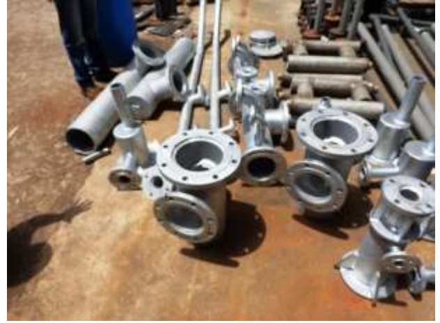
Foto nº 35 – Caixas de mar e filtros do 654
