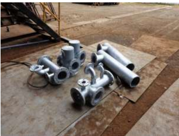
Foto nº 20 – Caixas de mar e filtros
