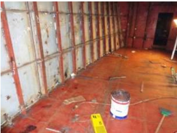
Foto nº 42 e 43 – Bloco do castelo posicionado e ponteado sobre o convés principal
