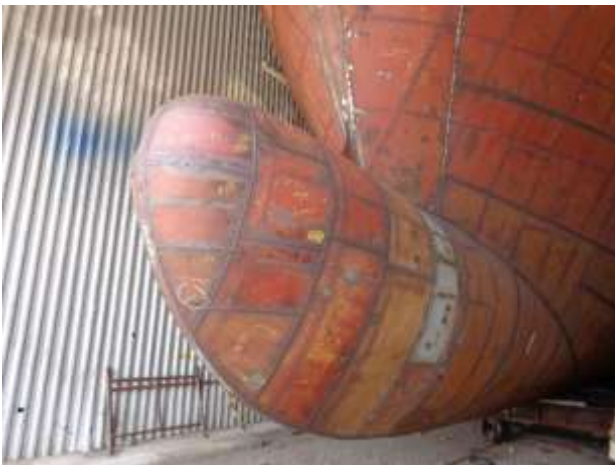
Foto nº 30 – Bulbo do casco 654 concluído
