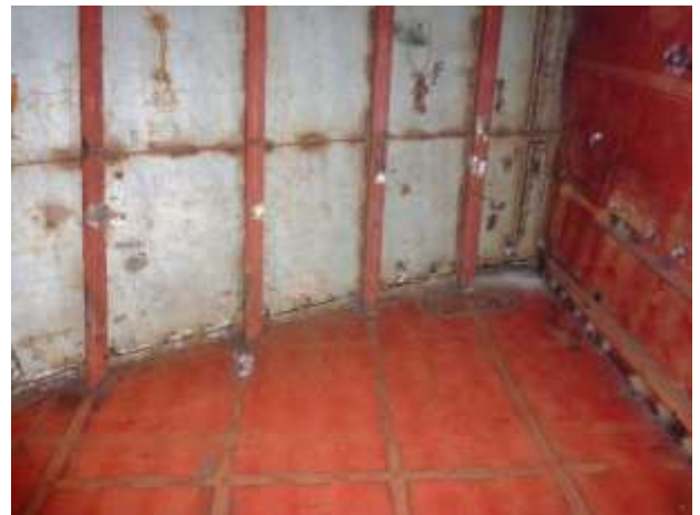
Foto nº 42 e 43 – Bloco do castelo posicionado e ponteado sobre o convés principal
