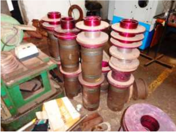
Foto nº 52 – Caixas de gaxetas
