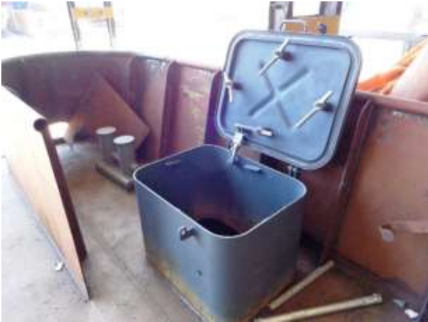
Foto nº 16 – Acesso maquina do leme
