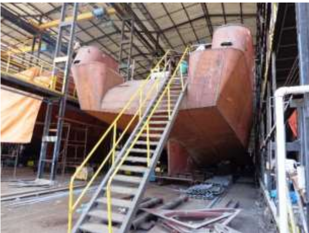
Foto nº 2 – Popa do casco 653. Antepara lateral do pavilhão removida
