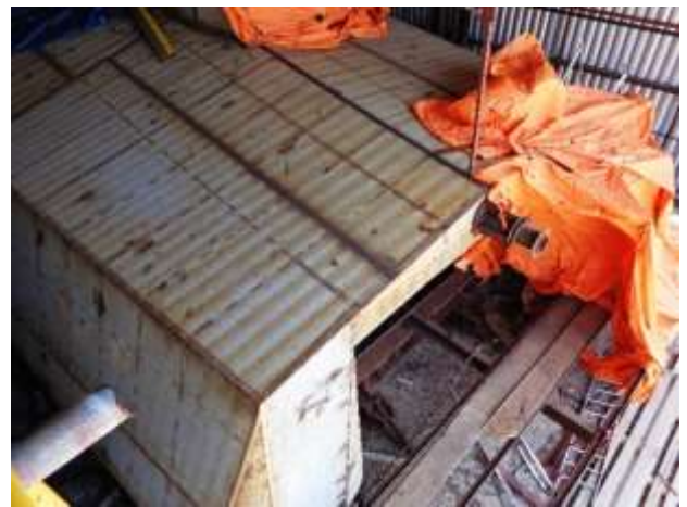
Foto nº 27 – Casco 655 com eixo para virar
