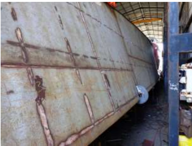
Foto nº 26 – Casco 655 com olhal para virada
