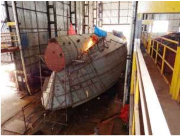
Foto nº 24 – Casco 655 pronto para virada
