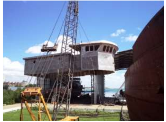
Foto nº 14 – Casaria sendo içada
