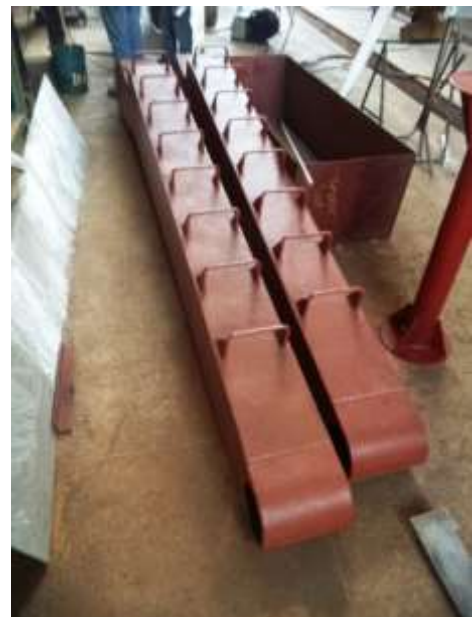
Foto nº 12 – Estrutura do A-Frame do 653
