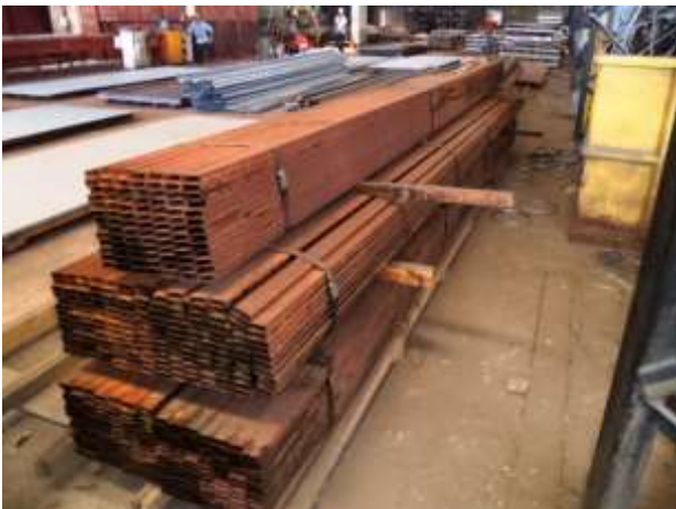
Foto nº 23 – Perfis de Metalon no deposito
