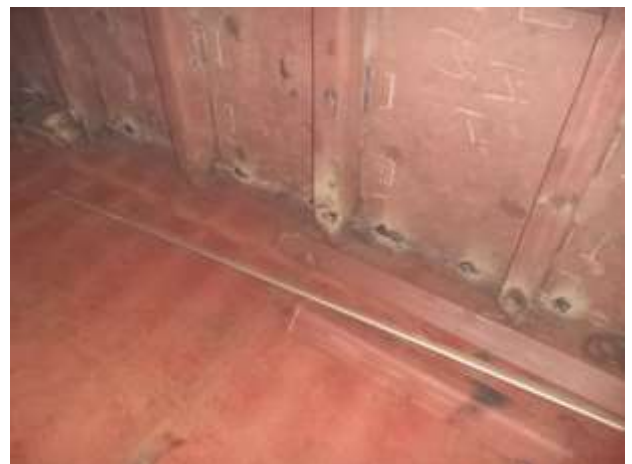
Foto nº 4 – Soldagem do castelo no casco
