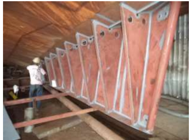
Foto nº 14 – SKEG sendo concluído
