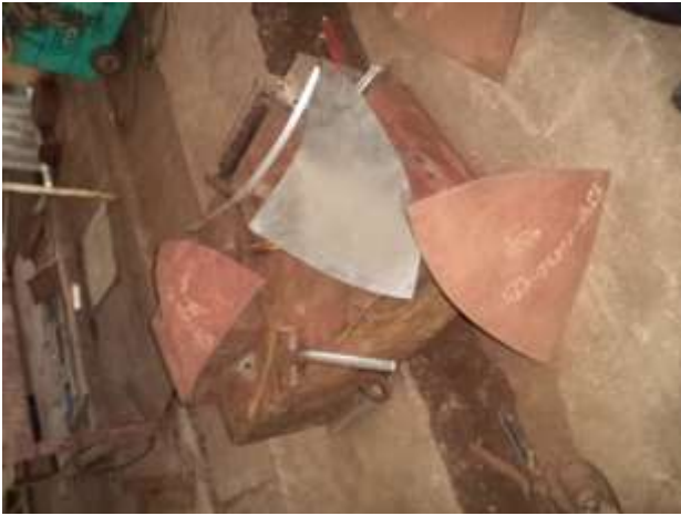
Foto nº 31 – Chapas para revestimento do bulbo
