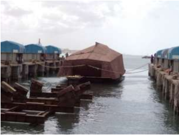
Foto nº 1 – Casco emborcado no syncrolift
