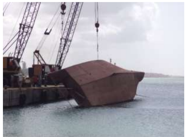
Foto nº 6 – Processo de virada
