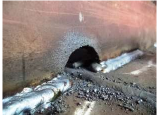
Foto nº 16 – Abertura para passagem de solda
