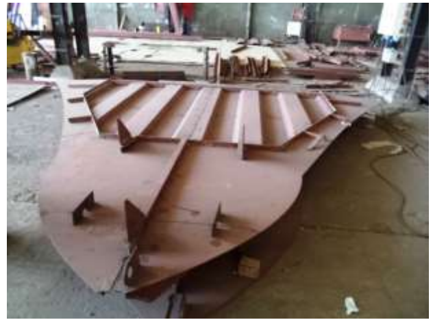
Foto nº 1 – Antepara do casco 654 Foto nº 2 – Antepara da região da proa casco 654
