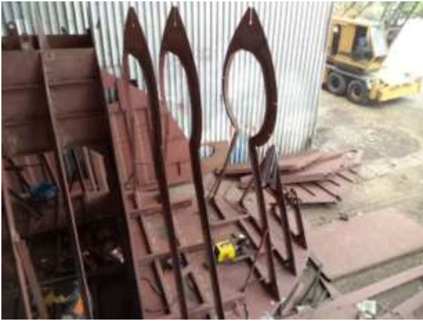
Foto nº 13 – Detalhe do bulbo do casco 653
