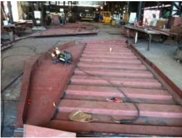
Foto nº 1 – Antepara do casco 654 Foto nº 2 – Antepara da região da proa casco 654
