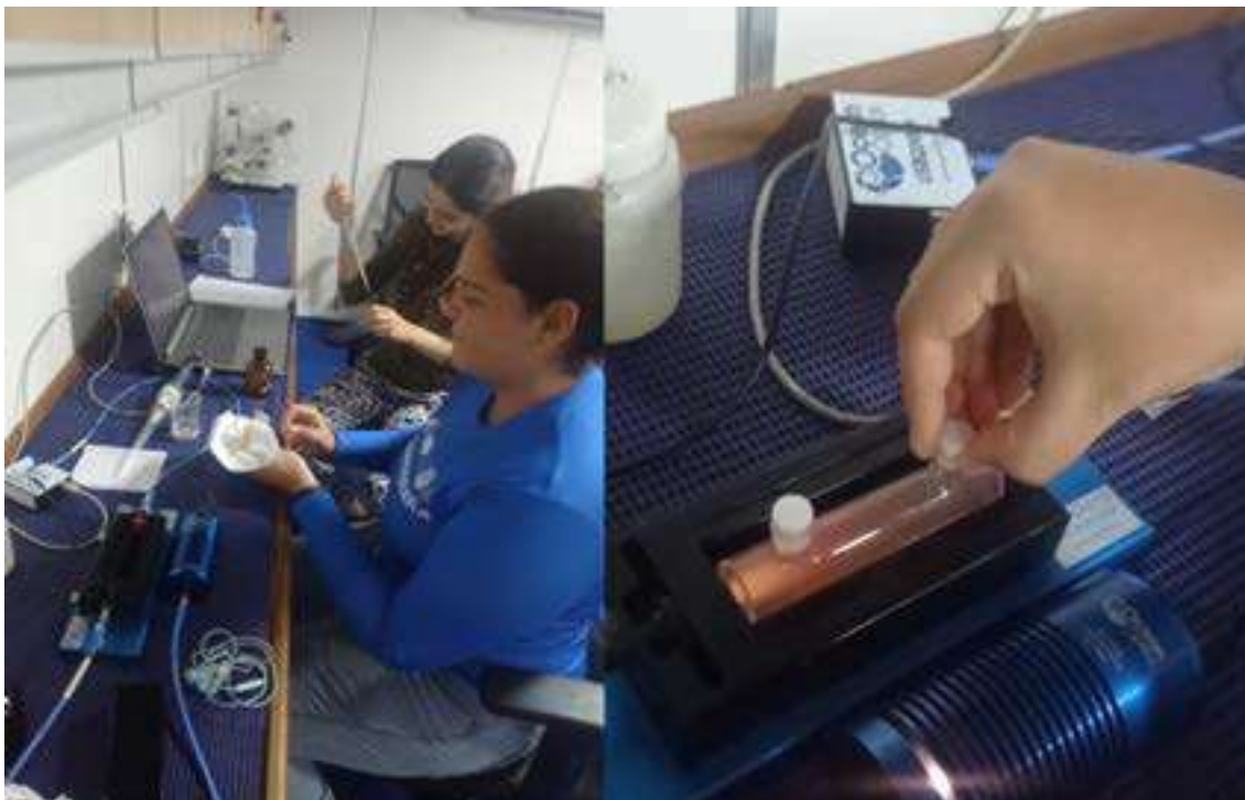
Figura 3 Laboratório Seco: Preparação da amostra para determinação do pH através de fotometria.
