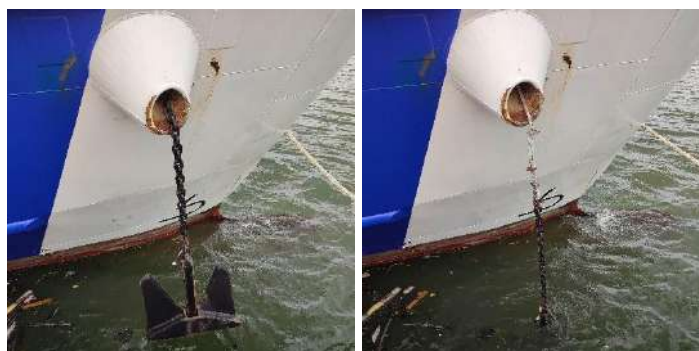
Figura 20. Exemplo de teste do dispositivo de fundeio.
