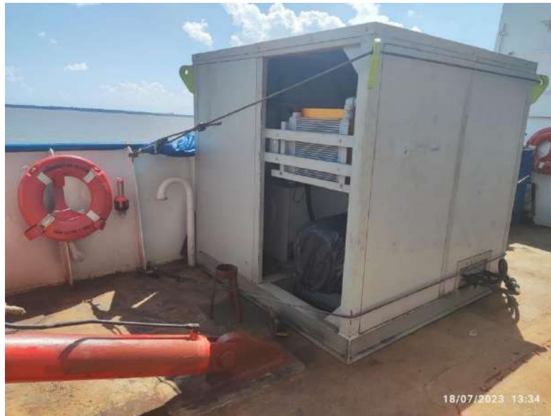
Figura 2-b) Unidade hidráulica do guincho oceanográfico.
