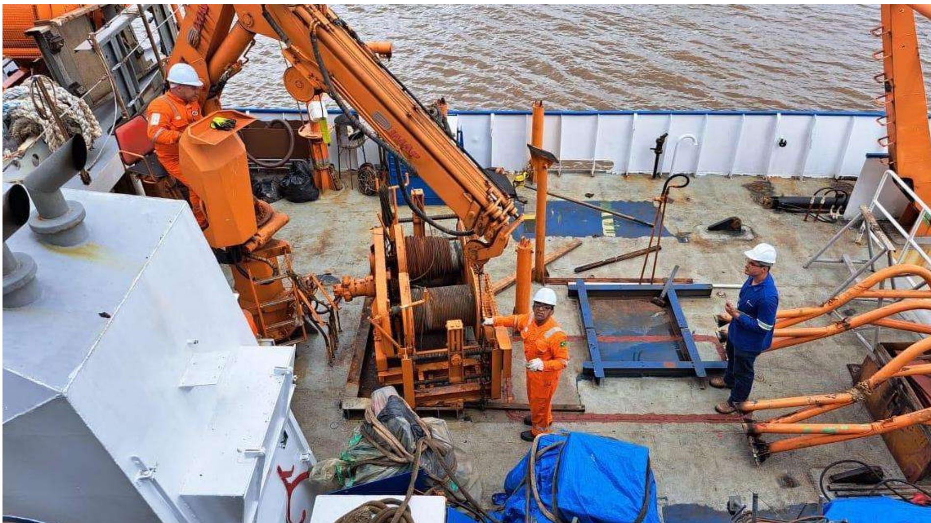
Figura 26: Retirada do guincho de pesca da embarcação. Este foi levado para a garagem da UFMA.
