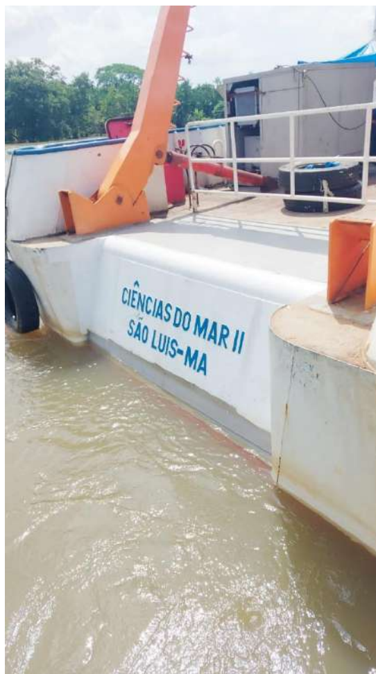
Figura 10c) Obra de expansão da popa concluída no NEP CM II.
