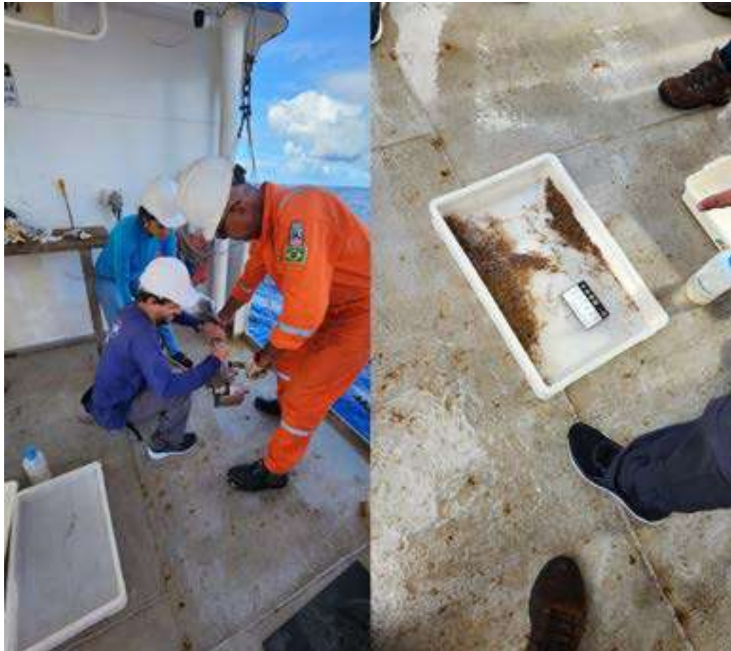
Figura 2 Convés: Preparação para lançamento do pegador de fundo do tipo Van Veen à esquerda. E à direita sedimento que foi amostrado.
