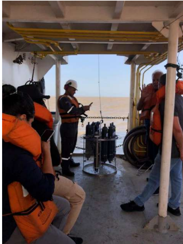
Figura 13 : Rosette com CTD operando no CM II. Por enquanto é possível apenas operar remotamente com fechamento das garrafas em as profundidades predefinidas. Em breve chegarão 1000 metros de cabo eletromecânico, a deck unit e os respectivos conectores quando será possível operar adequadamente a rosette.
