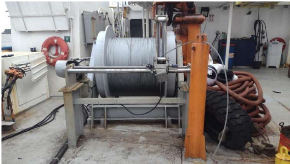
Figura 2-a) Guincho hidráulico instalado no navio.
