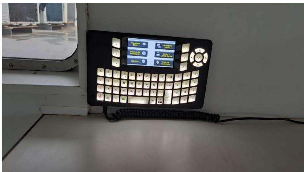
Figura 8b) Teclado do rastreador Onix que permite a emissão de até 300 SMS por mês.
