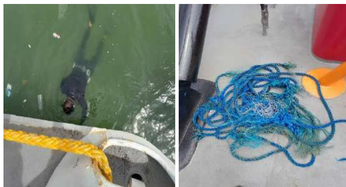
Figura 16. Material removido do eixo do hélice.
