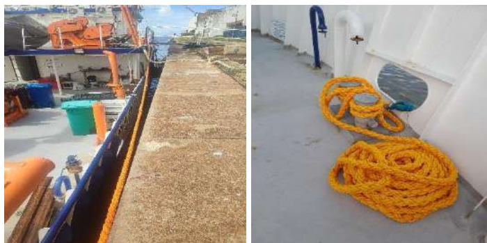
Figura 19. Espias de alta resistência utilizadas na atracação.
