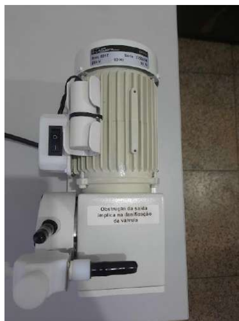
Figura 14 : Bomba de vácuo do sistema de filtração.
